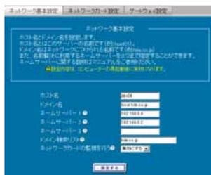
ネームサーバーの項目では、このマシン上に DNS サーバーを設定する場合は必ず、マシン自身をネームサーバー1に設定してください。例)127.0.0.1 等
